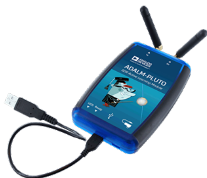
Figura 4.4: Ferramenta de desenvolvimento para RF – Analog Devices ADALM-PLUTO.
