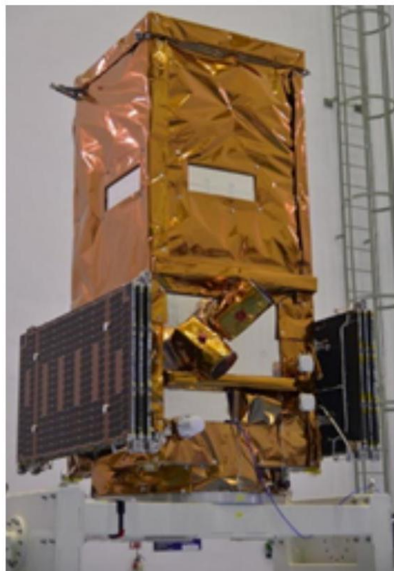
Figura 2.5: Satélite Amazônia 1 com MLI instalado.
