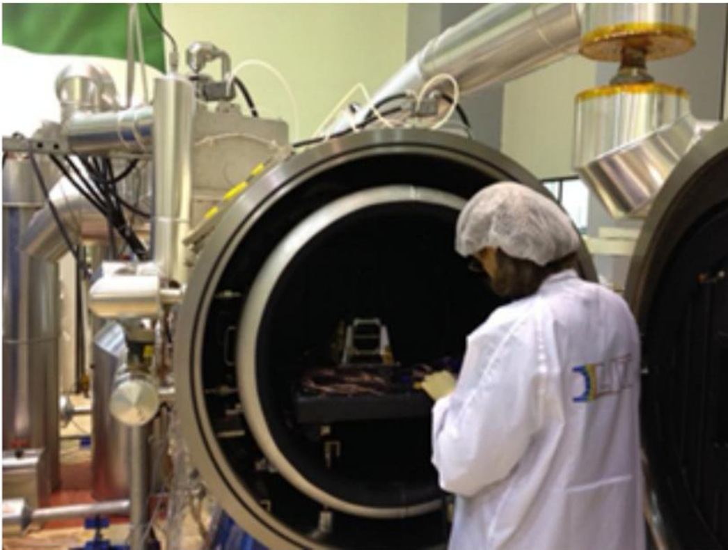
Figura 2.9: Preparação para o teste do protótipo térmico do NanoSatC-Br1.
