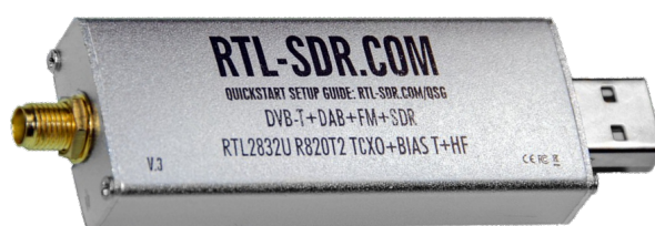
Figura 6.8: Módulo de Rádio Definido por Software, RTL-SDR v.3.
